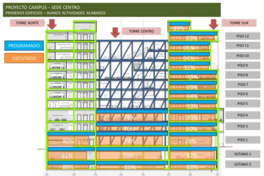
Ilustración 21. Avance en actividades de construcción (acabados)
