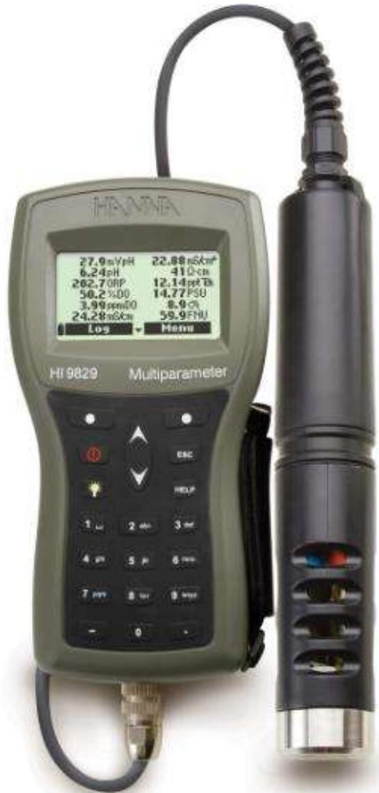
El HI9829 es un medidor multiparamétrico de registro portátil a prueba de agua que monitorea hasta 14 parámetros diferentes de calidad del agua.
