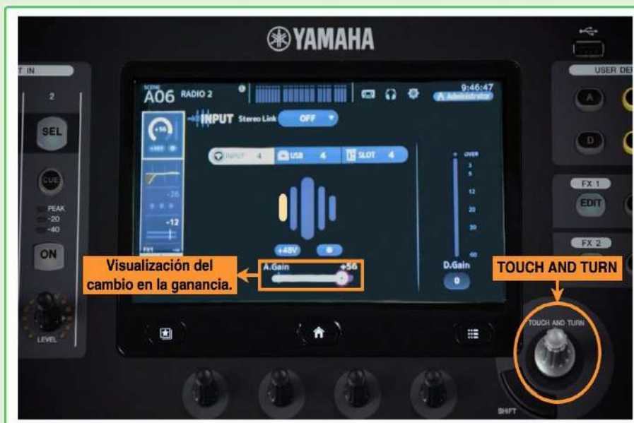
Imagen 18. Ajustes de ganancia en la consola de audio TF3.
