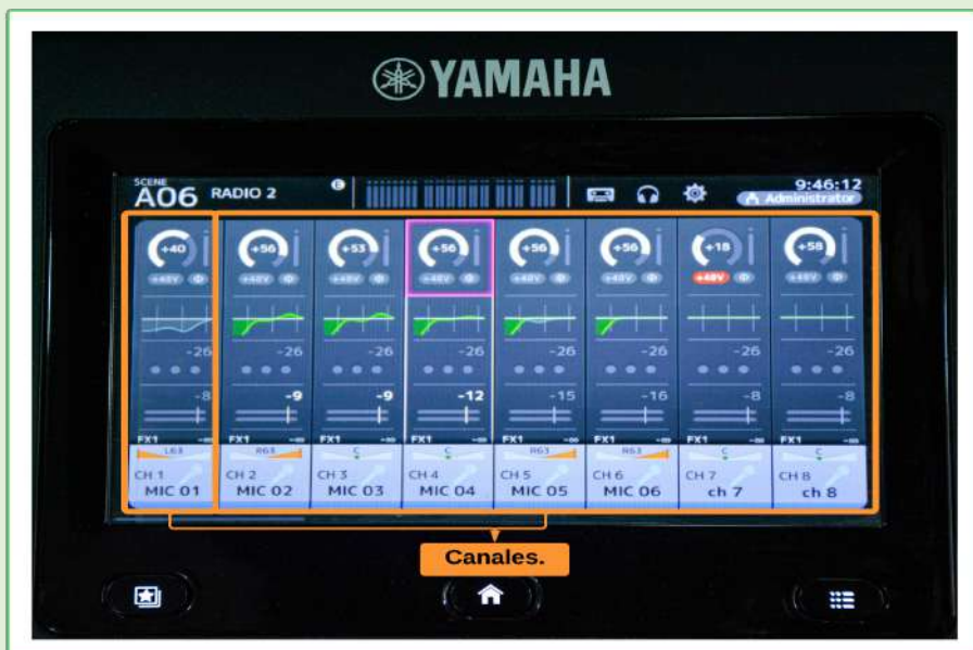
Imagen 16. Canales de la consola de audio TF3.
