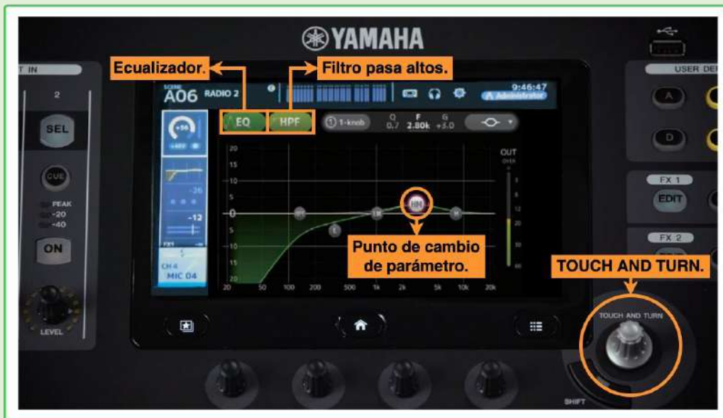
Imagen 19. Ajustes del ecualizador y filtro pasa altos.
