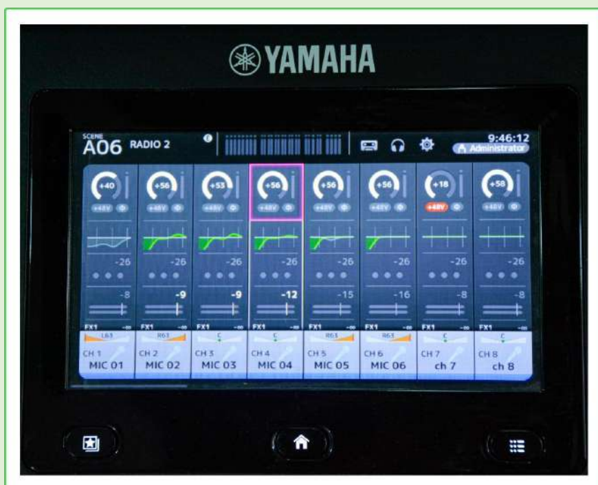
Imagen 14. Pantalla multitáctil de la consola de audio Yamaha TF1.
