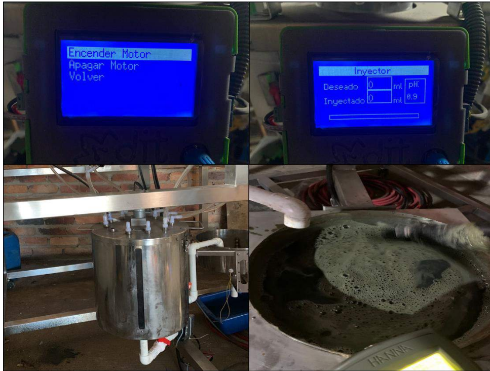
Imagen 18. Proceso Fenton-Like en la Planta de Nanorremediación
